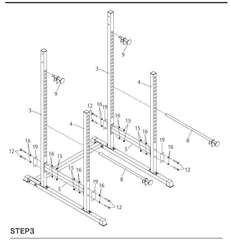
③リアフレームと④フロントフレームに⑤接続フレームを⑫六角ボルト (M10×75) と⑯ワッシャー (M10)、⑲補強プレートA、⑮ナット (M10)を使用してしっかり締め込みます。
