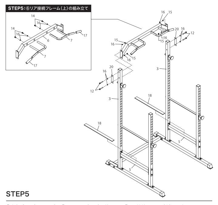
⑭六角ボルト (M10×20) と⑩ワッシャー (M10) を使用して、⑥リア接続フレーム (上) に固定してしっかり締めこみます。
